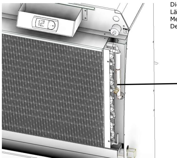
Die Füllung mit R407C soll bis zu einer maximale Länge von 8 Metern 1kg betragen, danach 48g pro Meter. Die Länge darf 15m nicht überschreiten.
