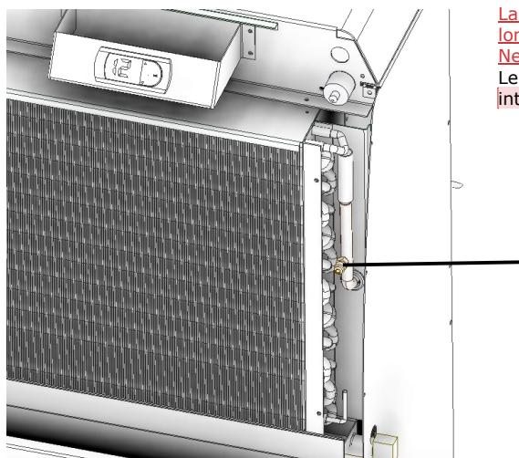
La charge de R407C doit être de 1 kg jusqu'à une longueur maximale de 8 mètres puis 48g par mètre. Ne pas dépasser 15 mètres
